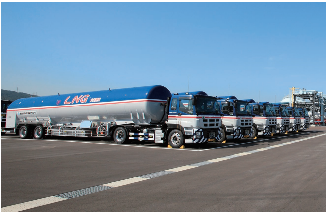
LNG Tank Trucks
